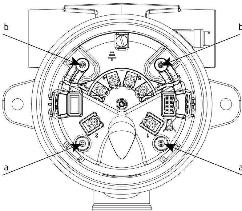
8. Отверните два винта (b), которыми крепежная база прикреплена к корпусу, и вытяните весь блок электроники.
