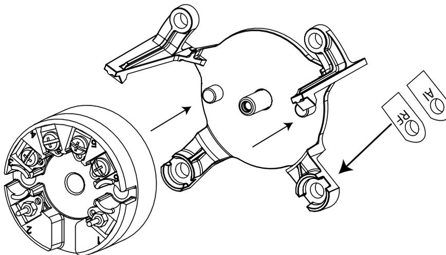
2. Надвиньте соединительный кронштейн на преобразователь с помощью направляющих в виде ласточкина хвоста.
