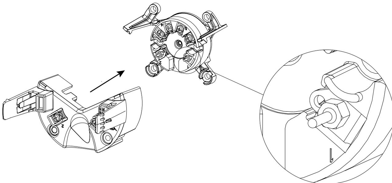
3. Снова вдвиньте блок электроники в корпус и затяните 4 винта (a + b), используя винты 28 мм для соединительного кронштейна (a) и 10 мм для крепежной базы (b).
