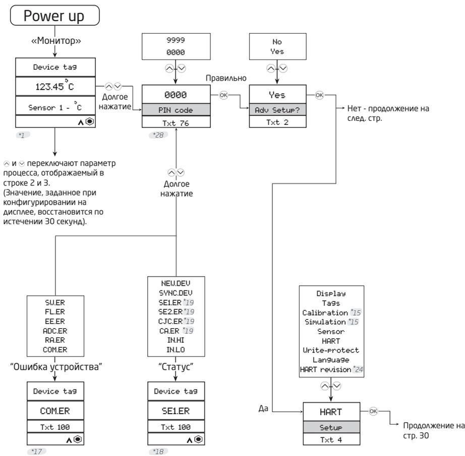
\*1 Если в течение 60 с не производилось нажатия кнопок (за исключением для меню Sim (Имитация) и Cal (Калибровка)), сохранения не производится и дисплей возвращается в режим мониторинга. Если активировано масштабирование показаний дисплея, также доступно значение масштабирования дисплея, по умолчанию отображаемое в режиме Мониторинг.
