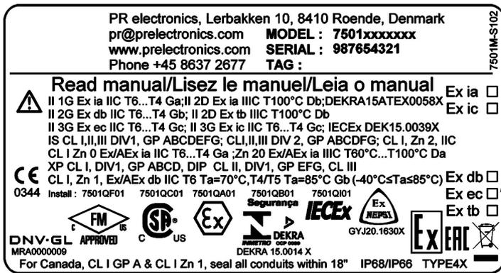
При установке данного продукта в качестве барьера взрывозащиты Ex ia, ic, db, ec или tb, отметьте тип установки на верхней этикетке в соответствующем поле, используя ударно-точечный маркератор.
