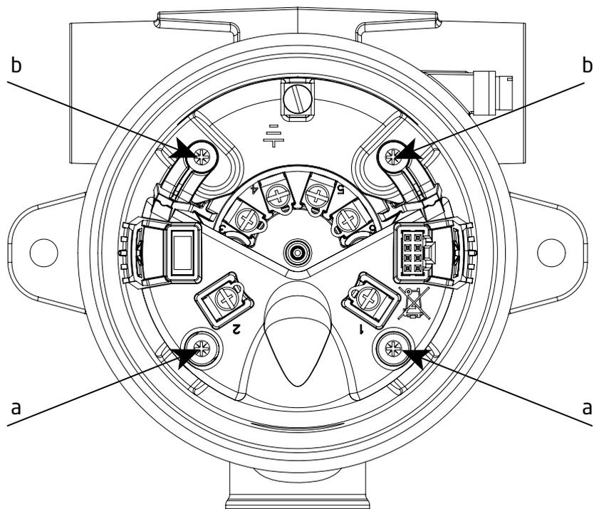
4. В заключение нащелкните на место блок дисплея и закрепите винтами крышку.
